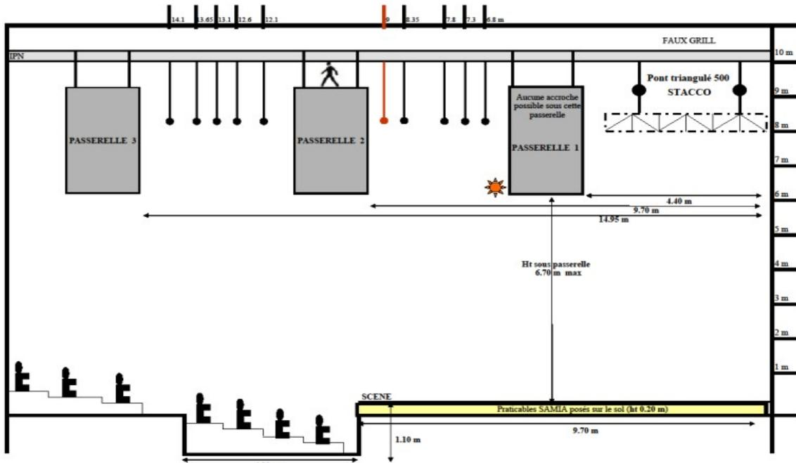
LEGENDE Echelle 1/50e NB :Capacité de la salle 685 sièges- si régie en salle reste 661 sièges Ecran de cinéma, à la polichinelle (6.70m x 14m)
