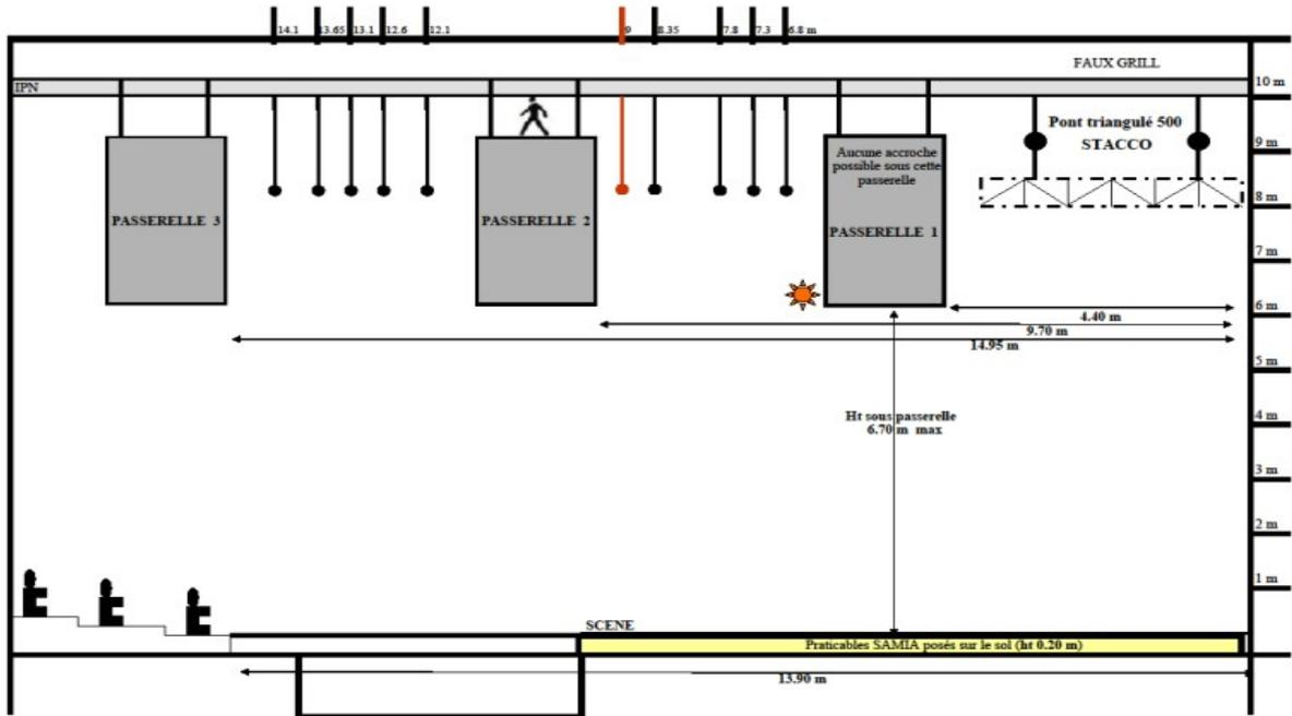
LEGENDE Echelle 1/50e NB :Capacité de la salle 566 sièges- si régie en salle reste 542 Ecran de cinéma, à la polichinelle (6.70m x 14m)
